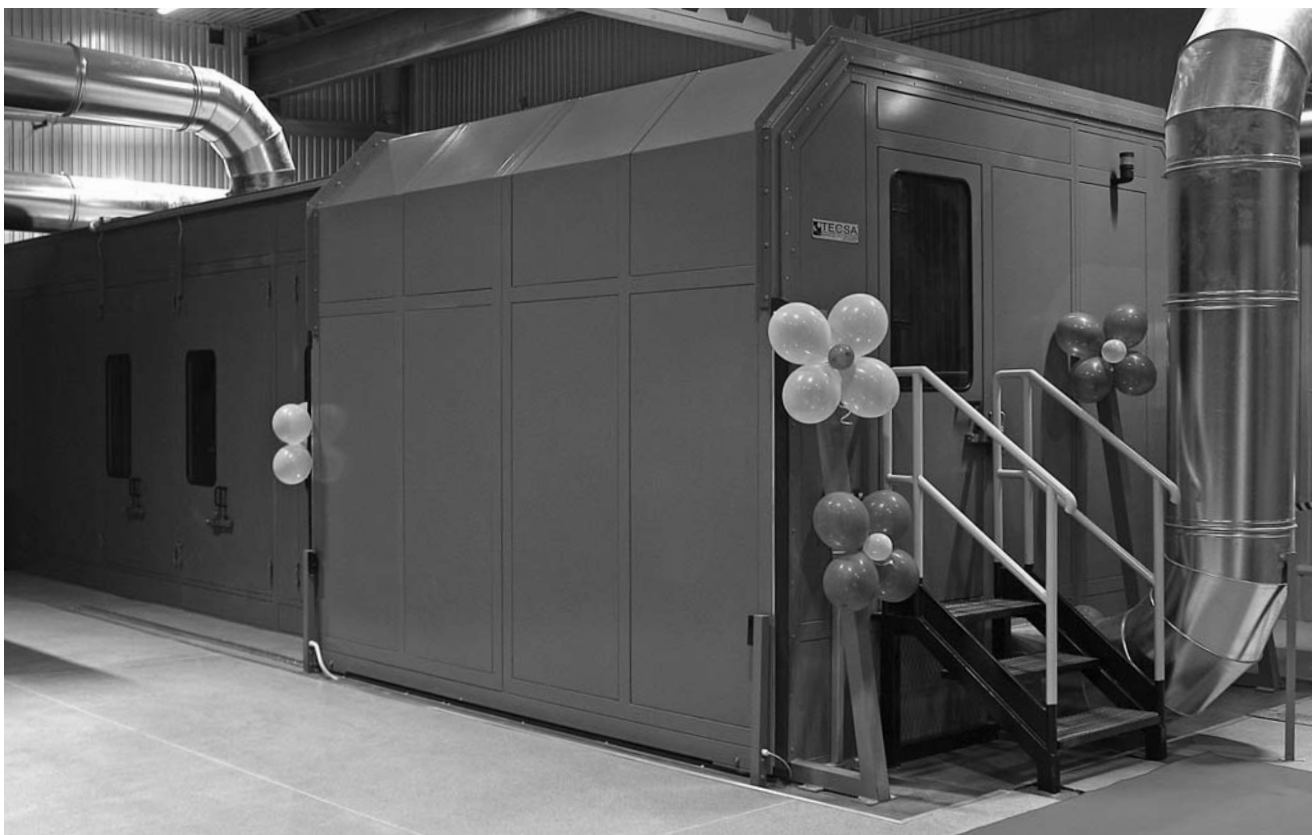
Тормозной стенд производства итальянской компании TecSA S.r.l. Для проведения точных испытаний колодок для легкового, грузового и железнодорожного транспорта в условиях, максимально приближенным к реальным. Подобные стенды существуют у считанных производителей колодок в мире. «Трибо» - в их числе.
